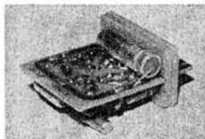
＜TRユニット・アンプの内部＞
