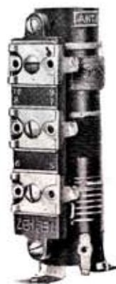
3バンドコイル3BR (BCバンドリッツ線バンク) 回路圖 No. 75 535\text{kc}\sim 1605\text{kc} ; 3.5\text{mc}\sim 10\text{mc} ; 8\text{mc}\sim 23\text{mc} 。ボビン徑 22\text{mm} 。
