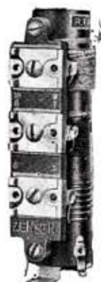
3バンドコイル3BR (BCバンドリッツ線バンク) 回路圖 No. 75 535\text{kc}\sim 1605\text{kc} ; 3.5\text{mc}\sim 10\text{mc} ; 8\text{mc}\sim 23\text{mc} 。ボビン徑 22\text{mm} 。
