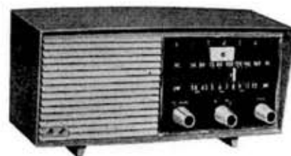
第11図 2バンド5球スーパー型ラジオ S-522
