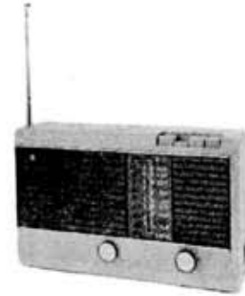
第 14 図 2 バンド 7 石オールウェーブ “ルーシー” WH-768 日立トランジスタラジオ
