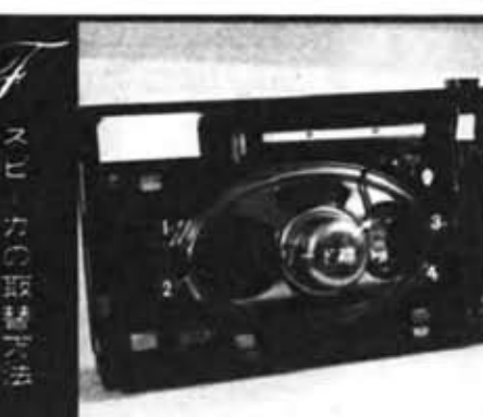
スピーカの取替方法 ビス1,2,3,4.とリード線をハンダゴテではずしますと、スピーカは取り替えられます。
