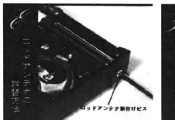
ロッドアンテナの取替方法 ロッドアンテナ取付けビスをはずしますと、取り替えられます。
