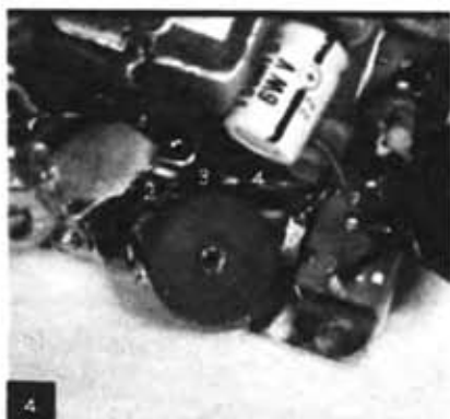
ボリューム関係のリード線をハンダゴテではずしますと、ボリュームは取り替えられます。
