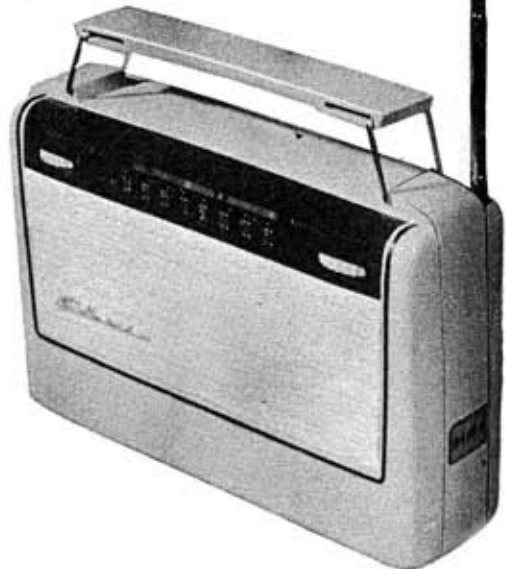
低周波増幅用のトランジスター回路にはプリント配線 を利用し、ためにコンパクトになっている。電源の方は A電池3個にて4.5Vを得、これをトランジスター電源 と真空管ヒーター(2系列に並列接続)にある。
