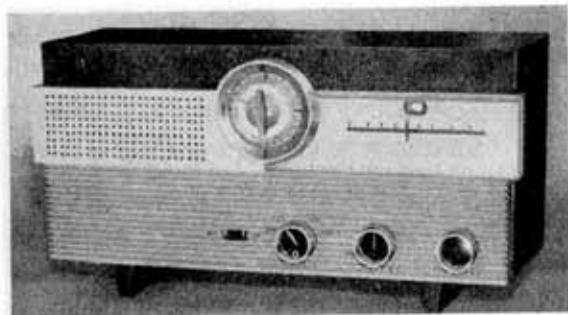
図 10.55 マツダラジオ “かっこう D” Matsuda radio receiver, Model 6TB-121
