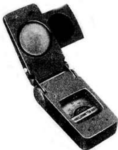
第11.1図 東芝照度計7号型 Toshiba illuminometer, type 7
