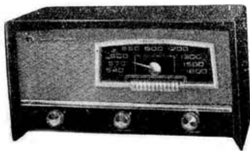
第10.16図 マツダラジオ(513G型, 5球スーパー) Matsuda radio receiver, type 513 G
